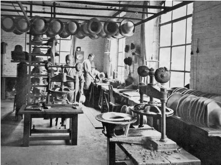
Steiferei. In der Steiferei wird der Hut in Form gebracht, aus: Firmenprospekt 1911.
